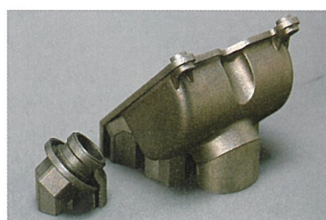
断面で見たときに照射面積が少なければ複数のパーツを一気に製作することができる。フロントチャンバーとドレンボルトは取外して斜めにレイアウトされ一度に複数作られた。
