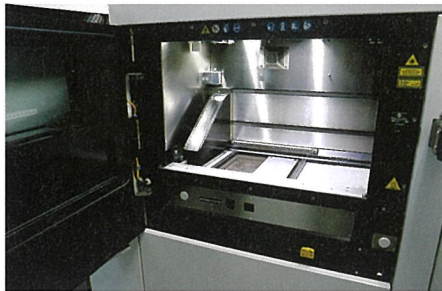
ドイツのEOS社製M 290機は最新鋭の「金属専用」3Dプリント専用機器。粉末の金属にレーザーを照射しその熱で金属粉を溶かして結合。その繰り返し積層によって立体部品を成型する。粉の金属を焼き固める焼結金属のようなイメージだと考えればわかりやすい。
