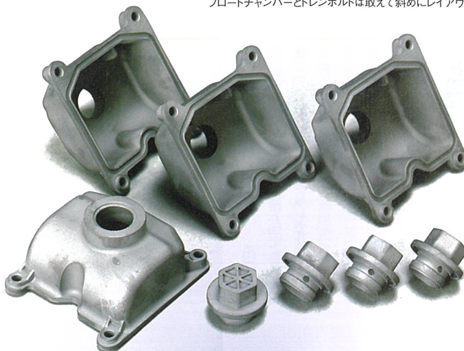
断面で見たときに照射面積が少なければ複数のパーツを一気に製作することができる。フロントチャンバーとドレンボルトは取外して斜めにレイアウトされ一度に複数作られた。
