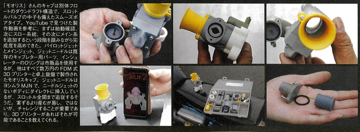
「モオリス」さんのキャブは別体フロートのダウンドラフト構造で、スロットルバルブの中子も備えたスムーズボアタイプ。YouTubeで見つけた製作動画を参考に、まずは始動確認、次にスロー系統、その次にメイン系を追加するという段階を踏みながら完成度を高めてきた。パイロットジェットとメインジェット、ジェットニードルは既存のキャブレター用パーツ、インシュレーターのOリングは市販品を使用するが、他はすべて数万円のFDM式3Dプリンターと卓上旋盤で製作されたモオリスキャブ。ジェットニードルはヨシムラMJNで、ニードルジェットのボディにダイレクトに挿入しているが、スロットル全開まで追従する。案ずるより産むが易し、ではないが、チャレンジすることが重要であり、3Dプリンターがあればそれが可能であることを教えてくれる。
