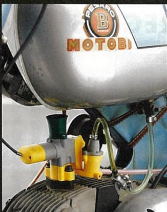
グッドオールデイズのパレードランを走った1960年代のモトビ125インベリアー。その特徴的な水平シリンダーの上に装着されているのは、なんとPLA(ポリ乳酸)で造形された樹脂製キャブレターだ!! 「モオリス」さんは物作りへの興味から数年前に3Dプリンターを購入。スーパーカブのハンドルスイッチ用品などを製作後、キャブレター作りを開始。分解清掃の経験はあるがキャブ自体の構造に詳しいわけではなかったが、YouTubeで実践例を見て「これなら自分でもできるかも」と、試作を繰り返してサーキット走行できるまでに至ったそうだ。「形状や構造が複雑でも図面ができれば具現化できるのが3Dプリンターの魅力です」と語ってくれた。
